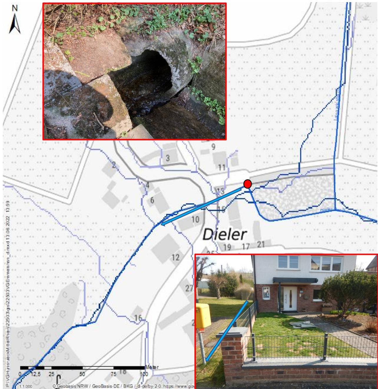
Abb. 4-11: Fließweg bei überlasteter Verrohrung
