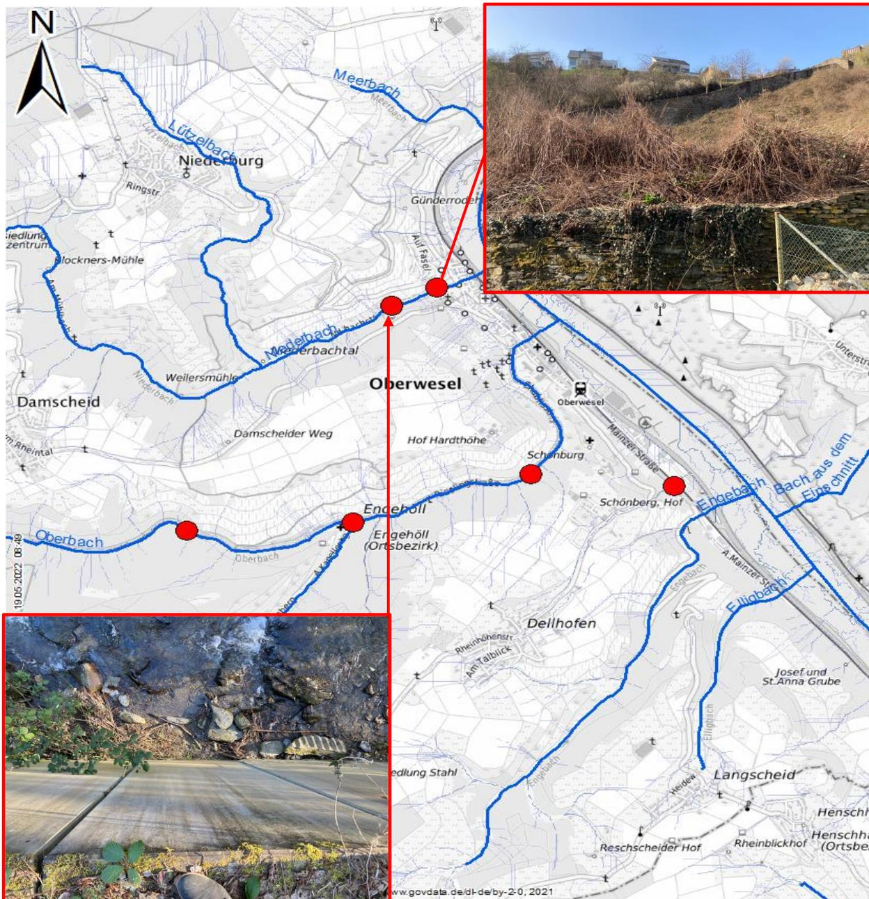
Abb. 4-89: Bewuchs an Steinstützmauern (oben), unterspülte L-Steine an Niederbachstraße (unten)
